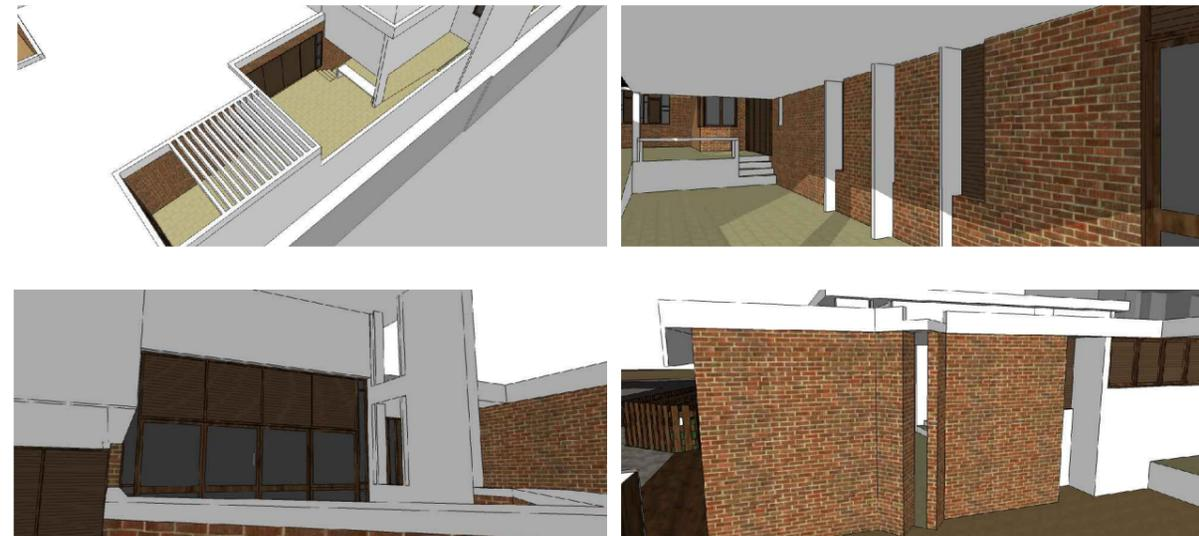
O ARQUITETO PROPÕS ELEMENTOS POUCO USUAIS PARA VENTILAÇÃO E SOMBREAMENTO DA CASA. EXISTEM ABERTURAS NA PRÓPRIA ESTRUTURA DA CASA QUE PERMITEM UMA MELHOR PASSAGEM DE VENTILAÇÃO E BRISES QUE TAMBÉM FAZEM PARTE DA ESTRUTURA DA CASA. UM PERGOLADO COMPLETA O SISTEMA DE PROTEÇÃO CONTRA A INSOLAÇÃO.
