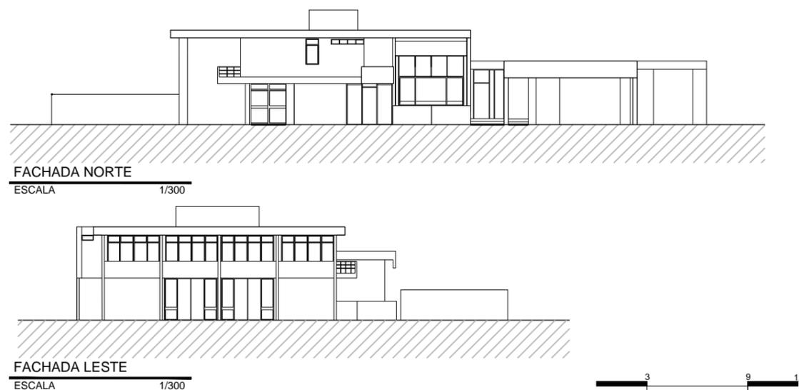
AS FACHADAS DA CASA CONTAM COM ELEMENTOS ESTRUTURAIS APARENTES, QUE SEGURAM NAO SÓ A COBERTURA MAS O PAVIMENTO SUPERIOR EM BALANÇO. AS VARANDAS ULTRAPASSAM OS AMBIENTES, FICANDO EM BALANÇO E CARACTERIZANDO A EXTENSÃO DO PLANO HORIZONTAL NA PLANTA. AS ESQUADRIAS DE MADEIRA, COM BRISES LATERAIS TAMBÉM SÃO ELEMENTOS MARCANTES NAS FACHADAS.
